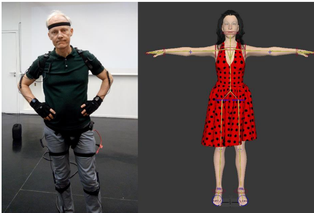
Figure 6. Combinaison de capteurs inertiels (gauche) et schéma des actuateurs 3D (droite)
