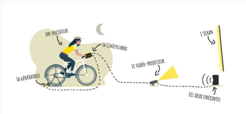
Figure 80 : schéma d'explication du principe de Cinécyclo - crédit : Cinécyclo.
